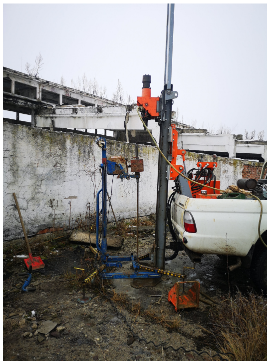
Foto 1. Aspectul terenului investigat și instalația de foraj geotehnic Pride Mount 20 și cu instalația de sondă de penetrare PDM utilizat.
